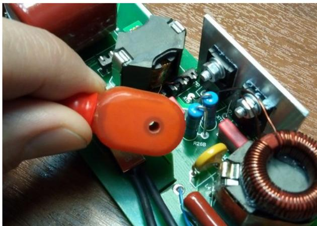
Миниатюрные неразъёмные пассивные токовые пробники Эфре серии 322 предназначены для измерения переменного тока в широком частотном диапазоне в электрических цепях малых размеров.
