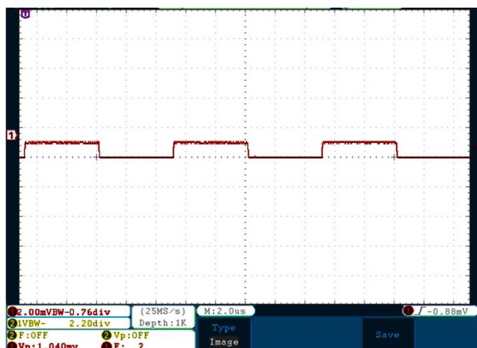
Осциллограмма тока в цепи нагрузки 500м±2% подключенной к выходу генератора импульсов с амплитудой 50мВ, масштаб по времени 2мкс/дел, масштаб по амплитуде 2мА/дел
