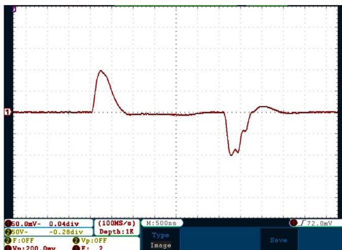
Осциллограмма тока в цепи затвора МДП-транзистора при его переключении, масштаб по времени 100нс/дел, масштаб по амплитуде 200мВ/дел.
