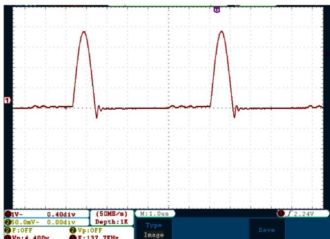
Осциллограмма тока в цепи резонансного контура квазирезонансного преобразователя напряжения, масштаб по времени 1мкс/дел, масштаб по амплитуде 1А/дел.
